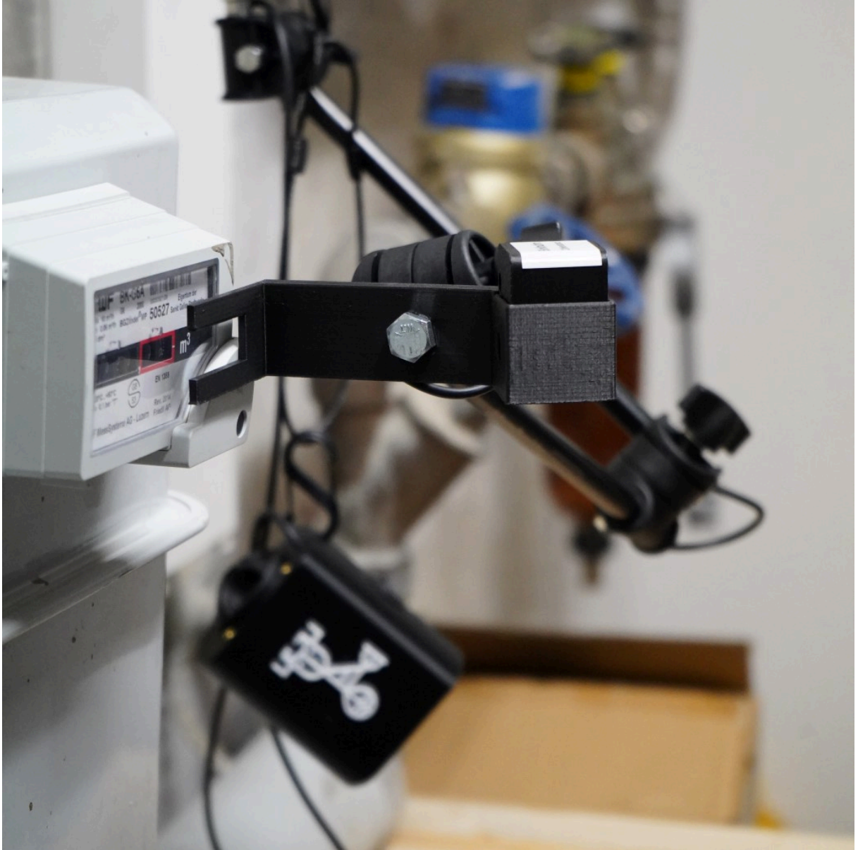
Abb. 2: Messaufbau Kamera Gaszähler
